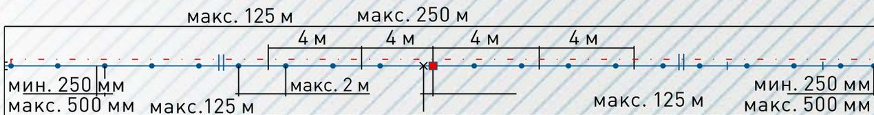
в) Для питания на стыке с линейным подводом на 1 м. шинпровода
