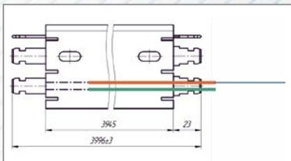
Индикаторы заземления (цветные полосы) при монтаже шинпровода надо располагать со стороны подкранового пути».
